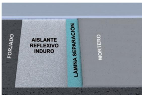
En suelos el aislante reflexivo INDURO evita que el calor se disipe hacia la planta inferior. Se recomienda colocar una lámina plástica para evitar el contacto directo del mortero sobre el aislante reflexivo.
