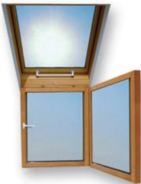
Con dos tipos de apertura: la **lateral** facilita la limpieza del cristal y la apertura **superior** la ventilación. Este tipo de ventanas necesitan un antepecho de al menos 90 cm para su colocación, como en una ventana normal de fachada.
