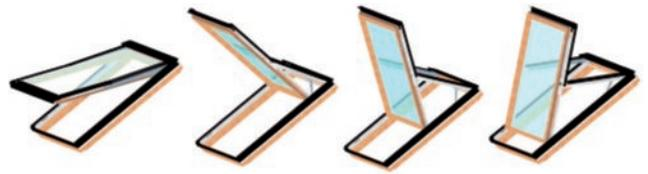
**El novedoso sistema de apertura proyectante deslizable**, que incorporan los modelos de la serie V400, permite que la hoja se sostenga en la posición de apertura deseada independientemente de la inclinación, entre 20° y 70°, de su tejado. Además posibilita el giro de la hoja casi completamente, aproximadamente 140°, facilitando la limpieza exterior de la misma.
